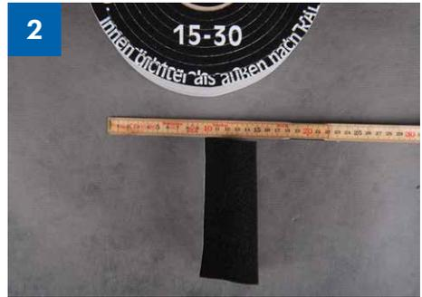
> Dicke von Ampacoll® Komprimax bei Entspannung.
