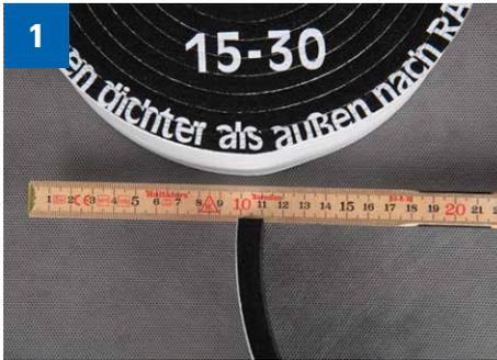
> Vorkomprimierung: Dicke von Ampacoll® Komprimax unmittelbar nach dem Öffnen der Rolle.
