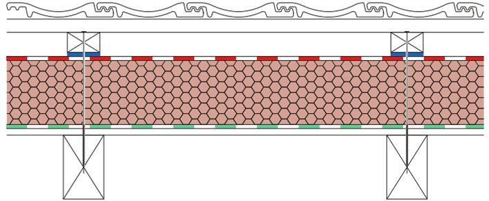
Einsatz als Luftdichtheitsbahn über der Tragkonstruktion bei diffusionssperrender Überdämmung mit **Ampatherm® PIR Alu (plus)**.
