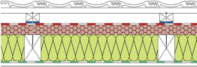
Schlaufenförmige Verlegung bei der Sanierung von aussen mit Entnahme der bestehenden Dämmung.
