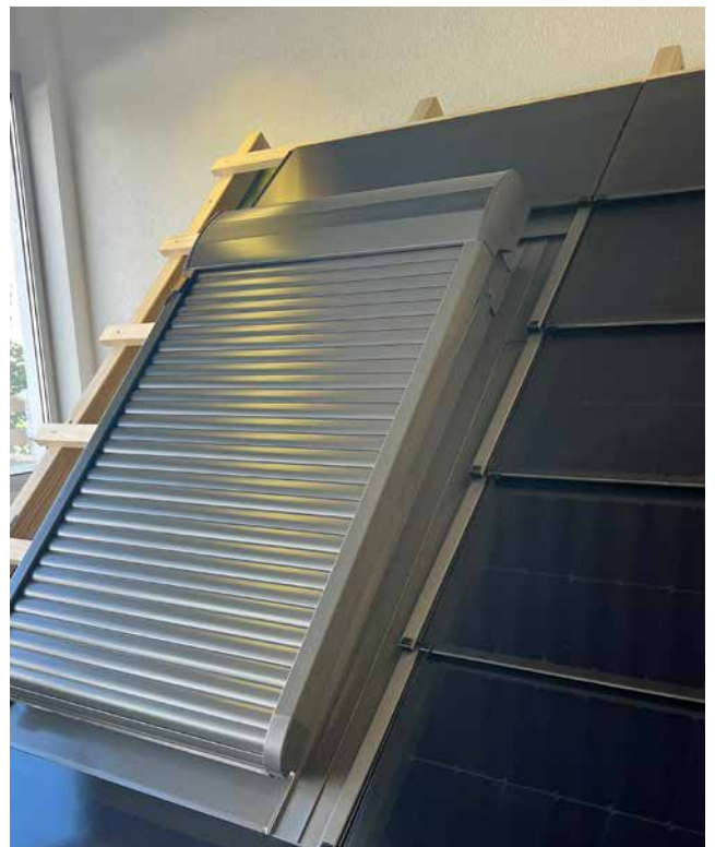
Dachfenster der Grösse MK06 78x118cm mit original VELUX ODL Eindeckrahmen, MATCH slate Module Mxx-HC24 (Optik totallyblack Crystal / Fjord)
