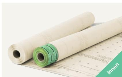
Gitterverstärkte, dreilagige feuchtevariable Dampfbremse und Luftdichtung aus Polyamid und Polypropylen. Perfekt geeignet für das Flachdach in Holzbauweise. Ebenso für die Sanierung von Steildächern mit dichter Außenhaut. Die Bahn bietet besondere Sicherheit im winterlichen Rohbau. Ideal für Einblasdämmstoffe dank hoher Reißwerte.
