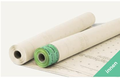
Gitterverstärkte, dreilagige feuchtevariable Dampfbremse und Luftdichtung aus Polyamid und Polypropylen. Perfekt geeignet für das Flachdach in Holzbauweise. Ebenso für die Sanierung von Steildächern mit dichter Außenhaut. Die Bahn bietet besondere Sicherheit im winterlichen Rohbau.
