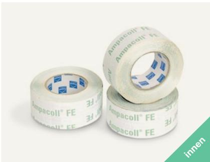
Auf Synthesefaserpapier aufgebracht modifizierter Acrylkleber mit Fadengelege. Klebeband mit klebfreiem Zwischenraum und geteiltem, abziehbarem Liner aus reißfester PE-Folie. Das ideale Klebeband für luftdichte Verklebung von Fensteranschlüssen, Eckverbindungen und an Plattenstößen.
