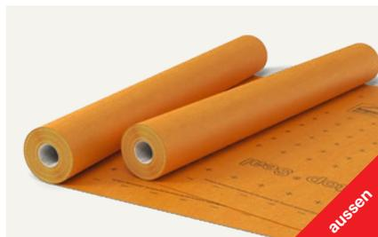
Dreilagige schweißbare Unterdeckbahn (UD Typ II) und Unterspannbahn (US) nach ÖNORM B 3661 und erhöht regensicheres Unterdach nach ÖNORM B 4119. Überlappungen und Anschlüsse werden fugenlos homogen verschweißt.
