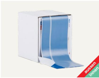
Einseitig klebendes, hochdehnbares Butylkautschukband zur Brüstungsabdeckung im Holzbau als Bauzeitschutz vor der Fenstermontage oder zur dichten Ausbildung von Unterfensterbänken. Ideal auch für die Überbrückung großer Fugen.
