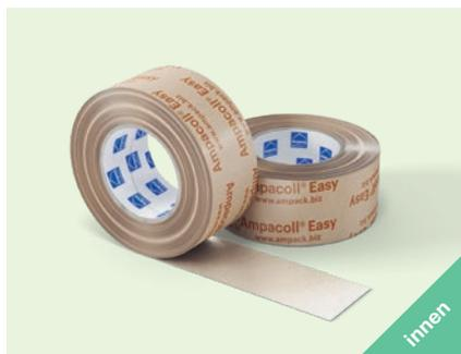
Acrylklebeband auf Papierbasis für die luftdichte Verklebung von Überlappungen bzw. Stößen bei Bahnen und plattenartigen Baustoffen, jeweils bei glatten Oberflächen im trockenen Innenausbau. Die Spezialbeschichtung ermöglicht die Verarbeitung direkt ab der Rolle, ohne Abziehpapier.
