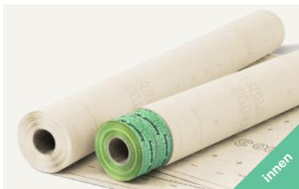
Gitterverstärkte, dreilagige feuchtevariable Dampfbremse und Luftdichtung aus Polyamid und Polypropylen. Perfekt geeignet für das Flachdach in Holzbauweise. Ebenso für die Sanierung von Steildächern mit dichter Aussenhaut. Die Bahn bietet besondere Sicherheit im winterlichen Rohbau. Ideal für die Ausblasdämmung dank hoher Reisswerte.
