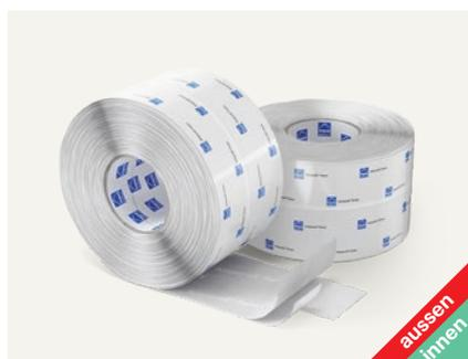
Putzanschlussband für den fachgerechten Anschluss von Dampfbremsen oder Holzwerkstoffmaterialien an unverputztes Mauerwerk oder Beton. Die luftdichte Schicht wird hergestellt mit dem anschliessenden Verputzen des Bandes.
