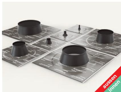
Manschetten zur radondichten Ausführung runder Durchdringungen im Baubereich in der Innen- wie Aussenanwendung (Sicherung mit Schlauchschelle erforderlich). Die Manschetten bestehen aus einem EPDM-Formteil, eingebettet in einen Flansch aus Aluminium mit einer Klebefläche aus Butyl.
