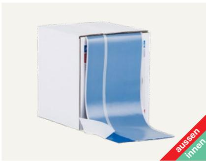
Einseitig klebendes, hochdehnbare Butylkautschukband zur Brüstungsabdeckung im Holzbau als Bauzeitschutz vor der Fenstermontage oder zur dichten Ausbildung von Unterfensterbänken. Ideal auch für die Überbrückung grosser Fugen.
