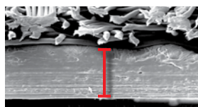
Couche fonctionnelle de Tyvek® Pro: 175 µm
