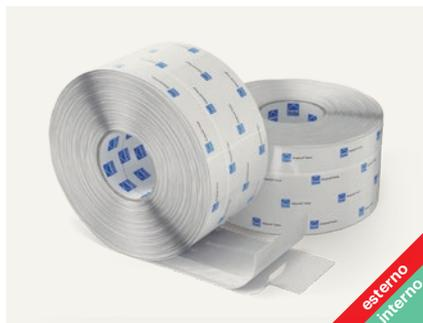
Il retro è adesivo su tutta la superficie, sul lato di tessuto non tessuto è applicata una striscia adesiva larga 20 mm. Questo nastro di raccordo per finestra è la soluzione ideale per la sigillatura ermetica di finestre o porte **prima** del montaggio.
