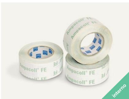
Nastro di carta ricavato da sintesi di fibre rivestito di adesivo acrilico modificato. Nastro adesivo con zona intermedia senza colla e pellicola di PE suddivisa, resistente allo strappo. Il nastro adesivo ideale per sigillature ermetiche all'aria dei raccordi alle finestre.
