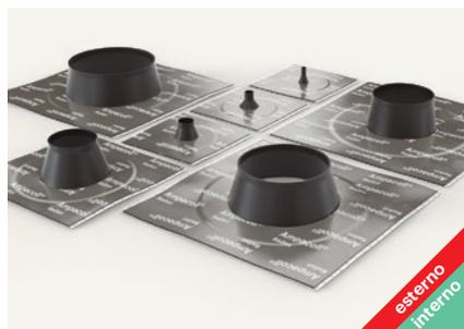
Manicotti per la sigillatura a tenuta di radon di elementi passanti tondi nel settore edile, per applicazioni interne ed esterne (Fissaggio con fascetta necessario). I manicotti sono costituiti da un pezzo sagomato in EPDM, incassato in una flangia di alluminio con una superficie adesiva in butile.
