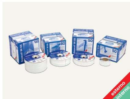
Collari sagomabili a mano. Nastro adesivo ad elevata flessibilità alla gomma butilica per la sigillatura durevole e semplice, previa applicazione di un primer, delle zone attorno agli elementi passanti attraverso lo strato di freno e barriera vapore quali correntini, travi, tubi, ecc. e sui giunti di pannelli in derivati del legno.
