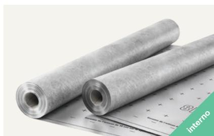
Barriera a quattro strati contro l'umidità e il vapore costituita da uno strato in alluminio e PE e da una rete in fibre rinforzate termicamente con strato di riempimento in PP (100% polipropilene). Idonea per isolamento.
