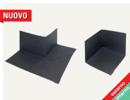
Angoli interni ed esterni autoadesivi prefabbricati per realizzare in breve tempo raccordi permanentemente ermetici all'aria e al vento nonché flessibili, ad esempio per finestre, porte, ecc. Supporto in materiale composito in tessuto non tessuto stabile ai raggi UV per impiego esterno.
