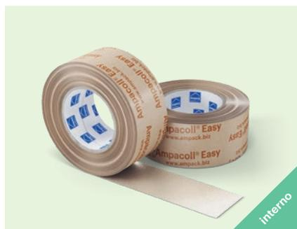
Nastro adesivo acrilico a base di carta per l'incollatura a tenuta d'aria di sovrapposizioni e giunti nei teli e nei materiali a pannelli, su superfici lisce per finiture interne a secco. Il rivestimento speciale consente la posa direttamente dal rotolo, senza carta rimovibile.
