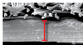
Tyvek® Pro Funktionsschicht: 175 µm
