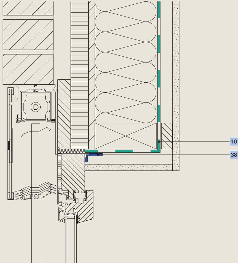
10 Dampfbremse **Ampatex® DB 90**
