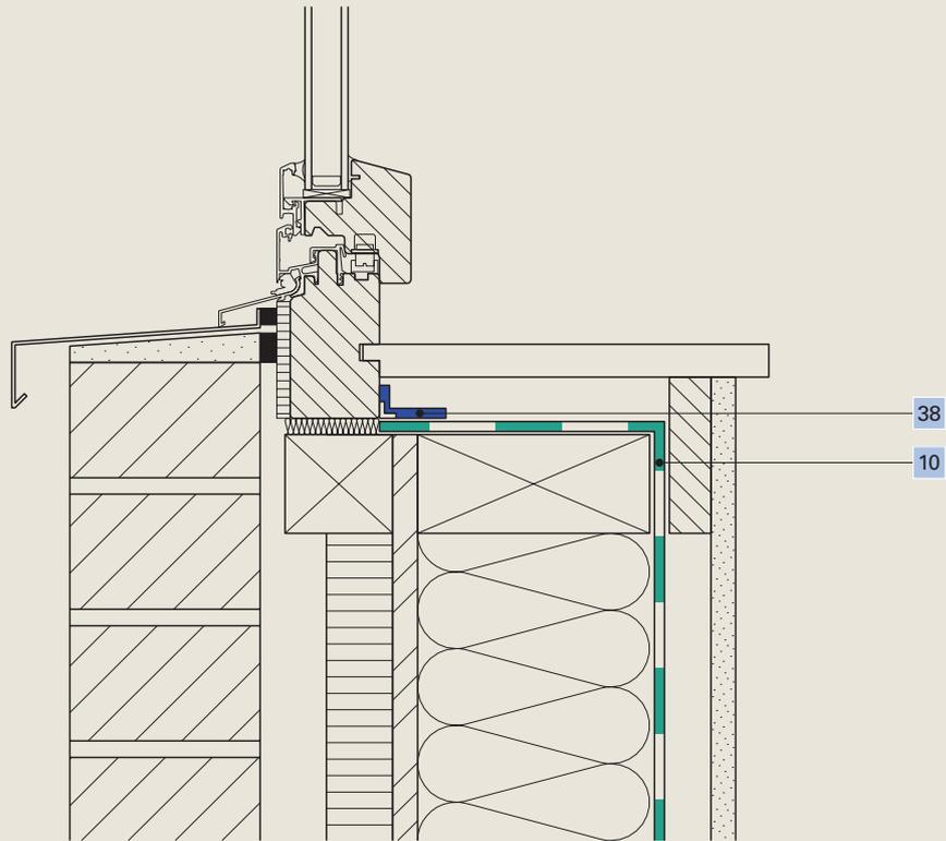
10 Dampfbremse **Ampatex® DB 90**
