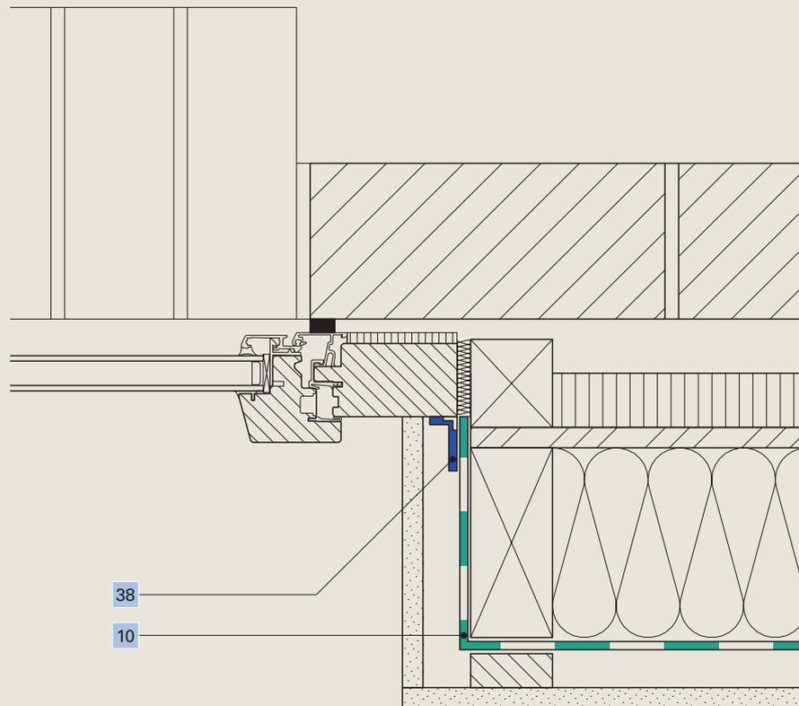
10 Dampfbremse **Ampatex® DB 90**
