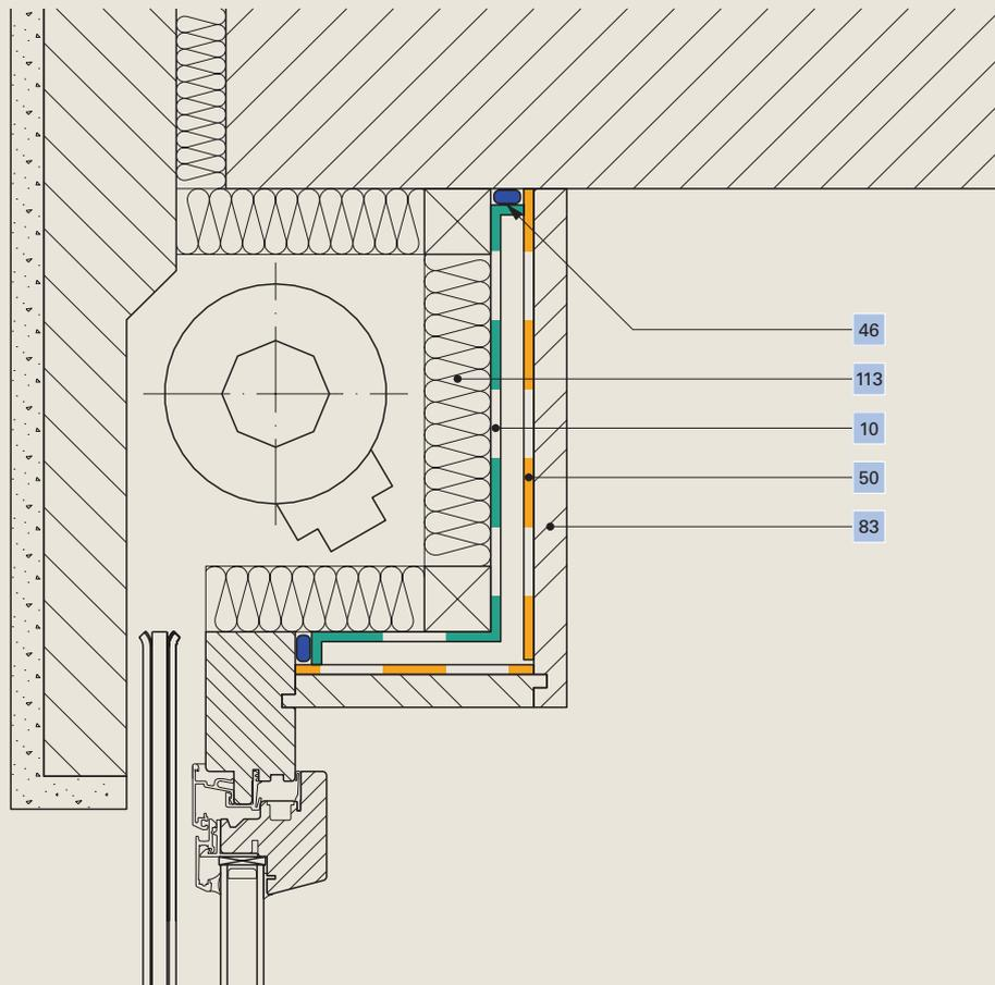
10 Luftdichtheitsschicht **Ampatex® DB 90**
