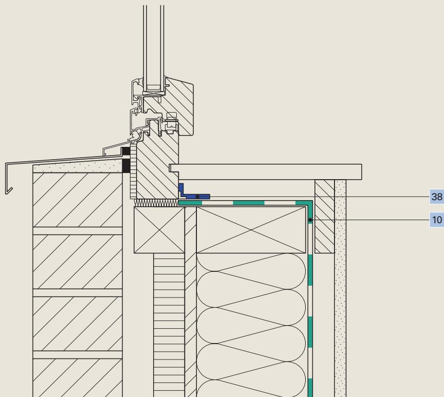
10 Dampfbremse **Ampatex® DB 90**
