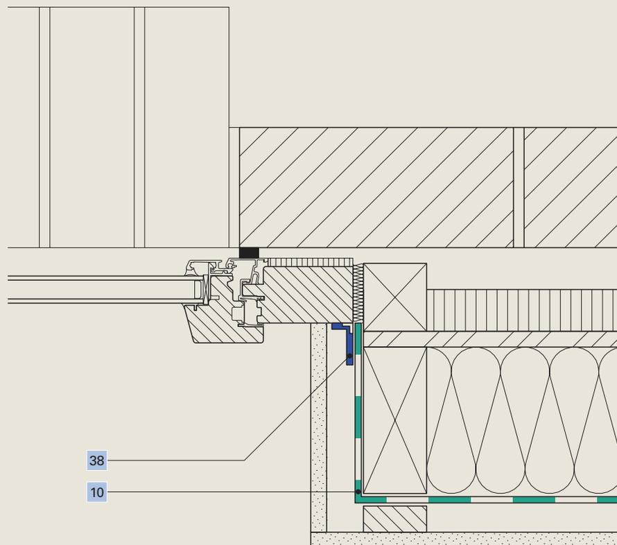
10 Dampfbremse **Ampatex® DB 90**
