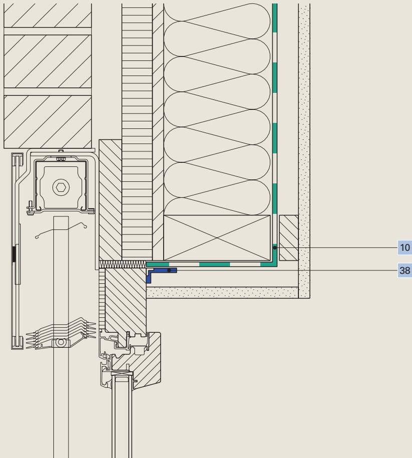
10 Dampfbremse **Ampatex® DB 90**
