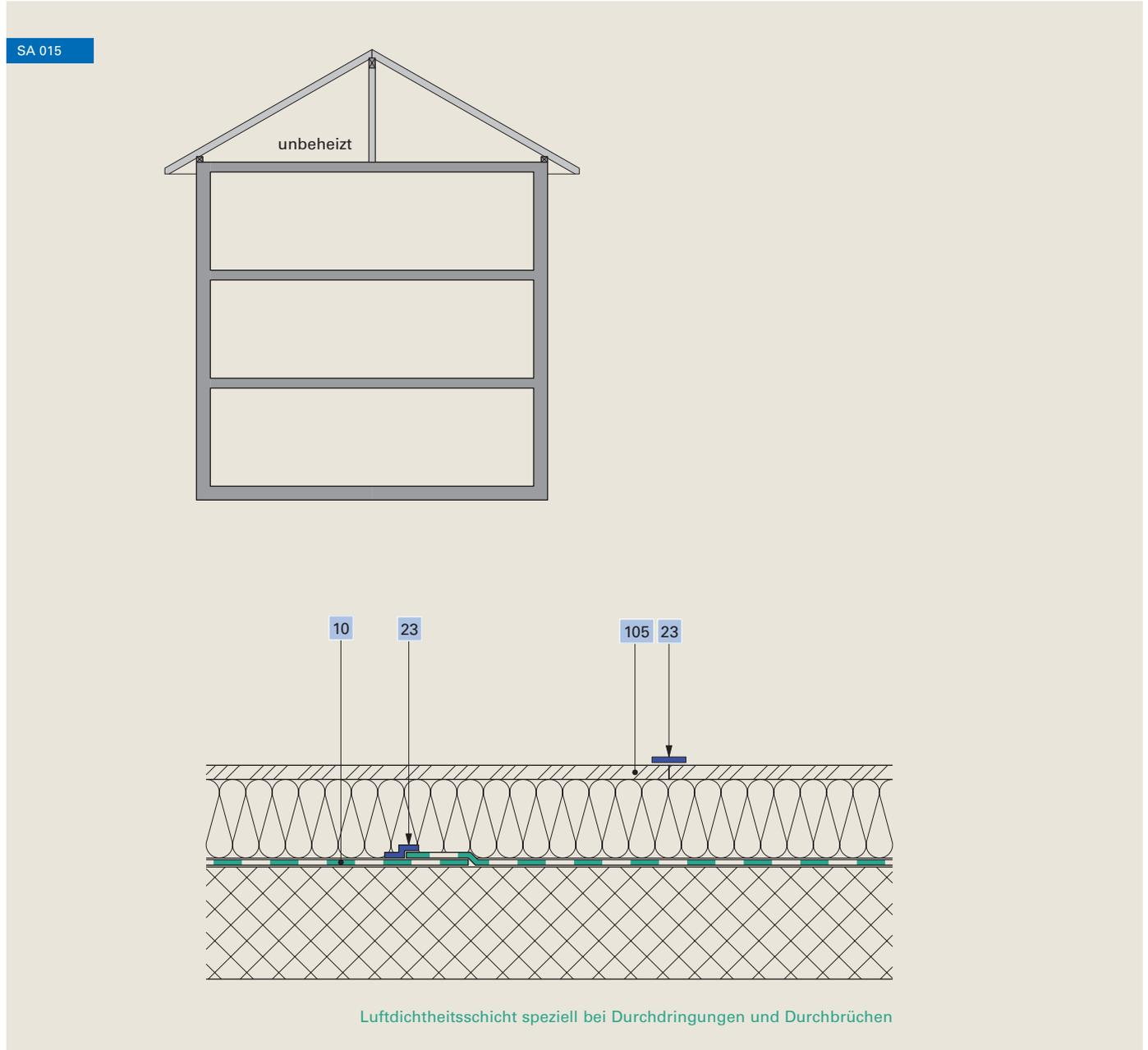
10 Schalungsbahn **Ampatex® SB 130**, Dampfbremse **Ampatex® DB 90 / Ampatex® Cento**
