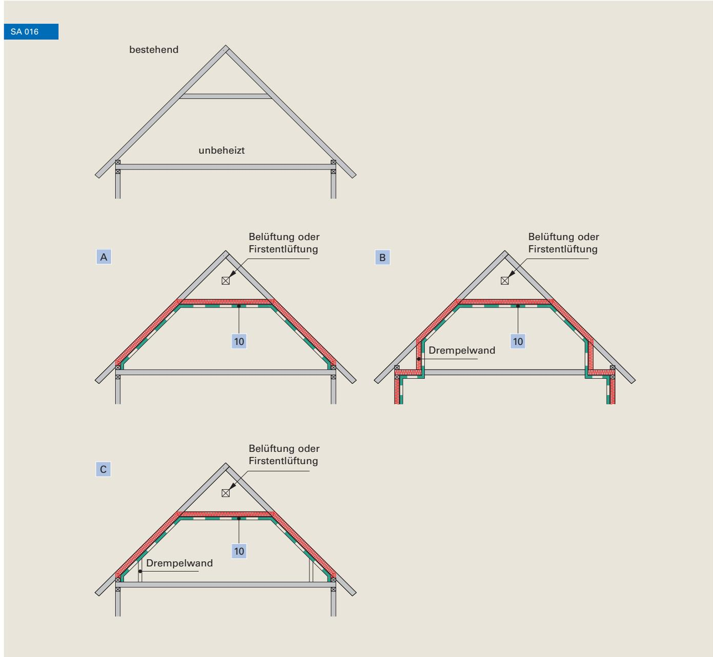
10 Dampfbremse Ampatex® DB 90
