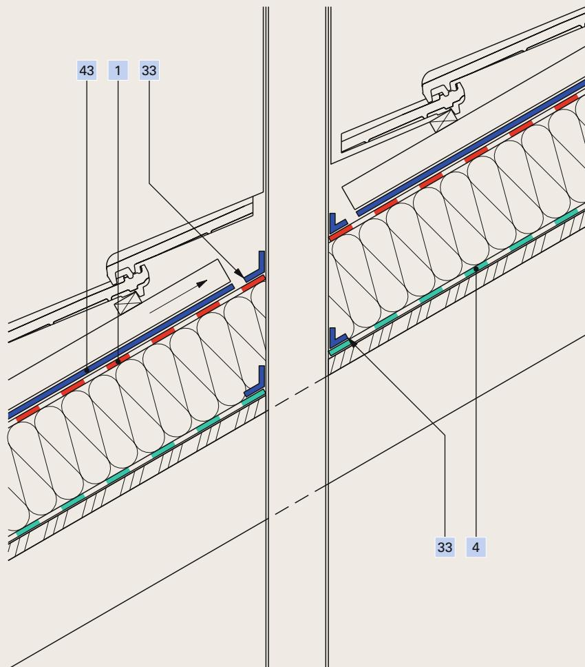
1 Telo di sottotetto Ampatop® Protecta (plus)
