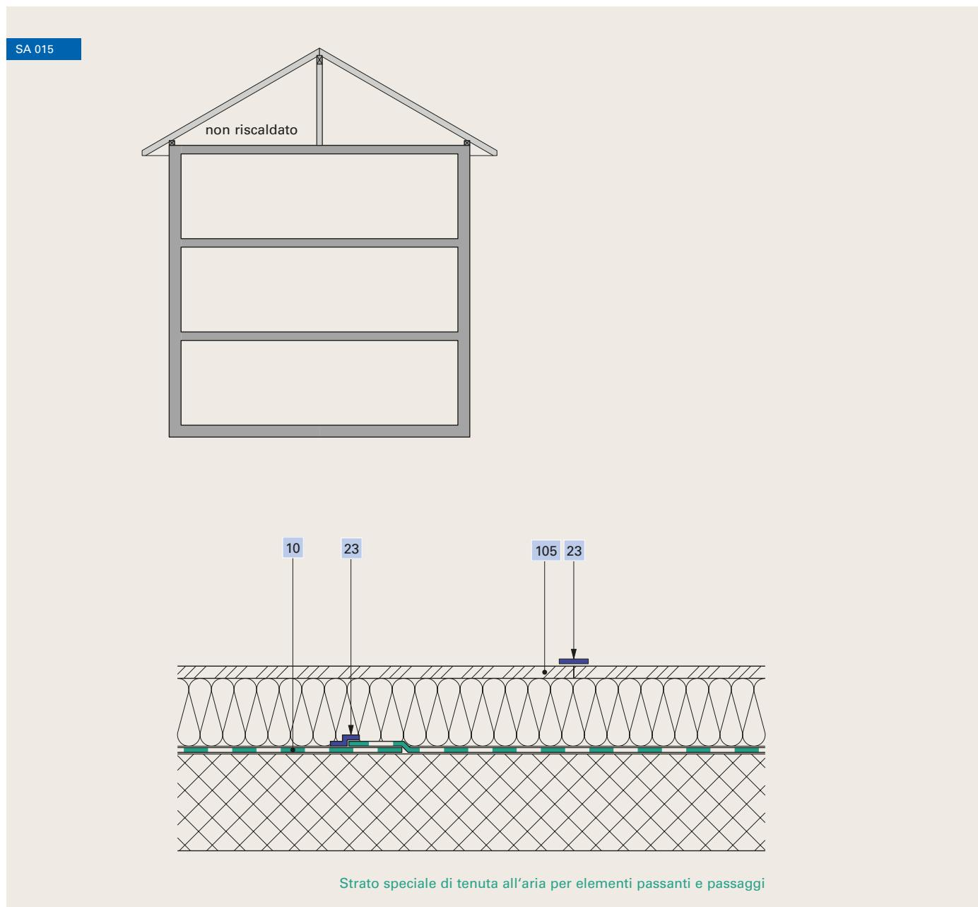
10 Telo d'assito Ampatex® SB 130, Freno vapore Ampatex®
