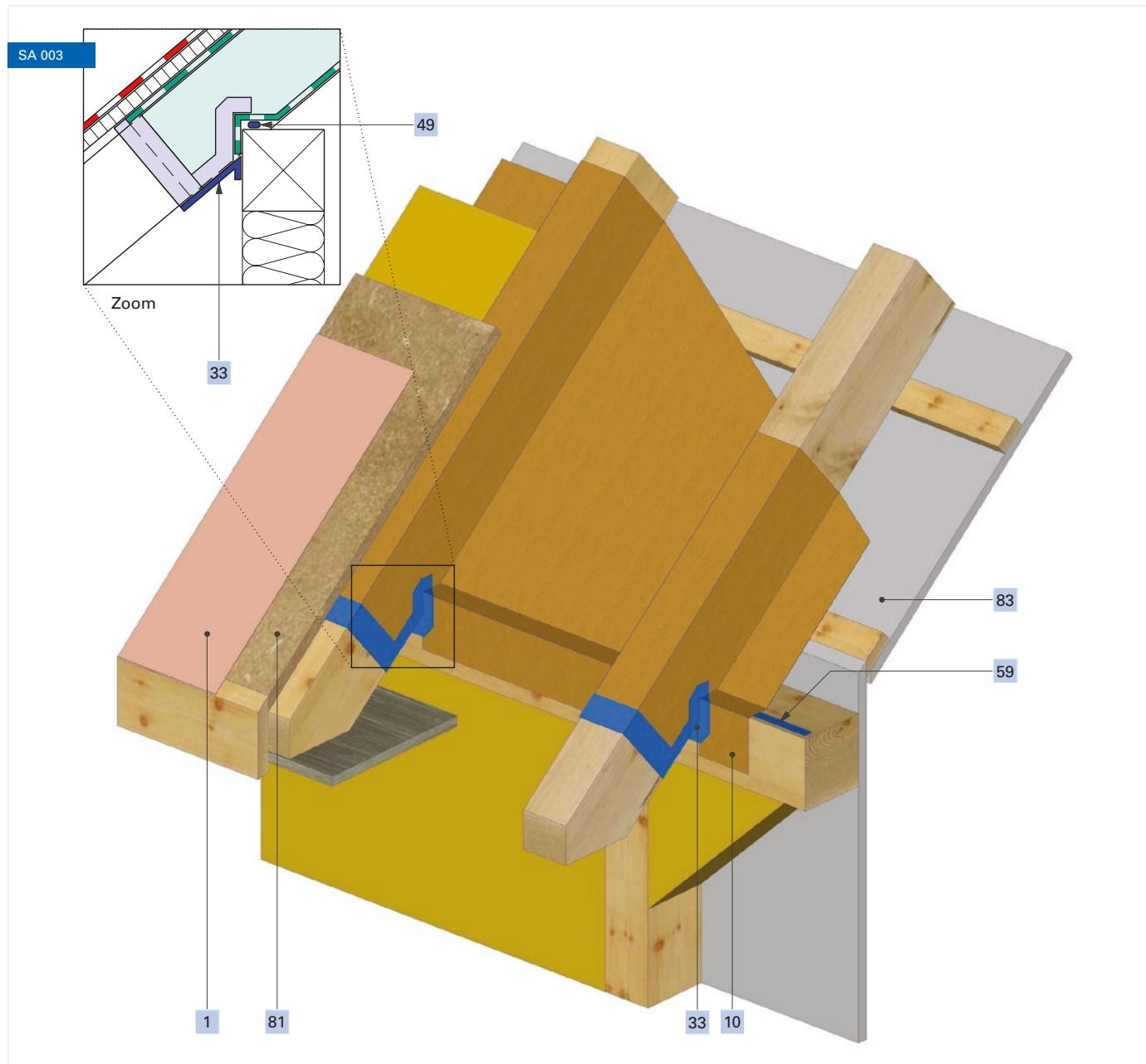
1 Telo di sottotetto Ampatop® Protecta (plus)
